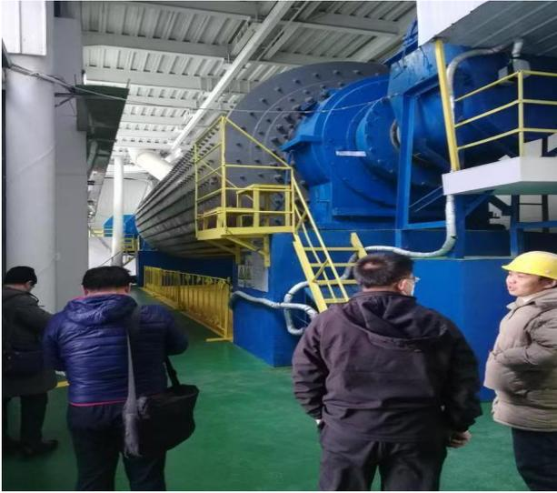
磨机研磨体采用陶瓷球，因为超减少吨地聚物胶凝材料的粉磨电耗，超细粉磨目前都采用管磨机，磨机的研磨体都使用钢球、钢锻，粉磨电耗偏高，超细粉磨电耗在 60 多 kw.h/t，这样给系统粉磨电耗带来不小的压力，
