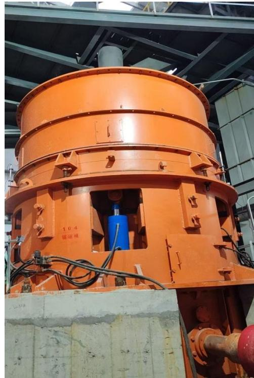
优点 5，辊压机更换一次辊皮造价昂贵，辊碾机更换碾辊碾盘价格较低。采用辊碾机预粉磨，由于辊碾机的特有结构，及宽棍面，薄料层，锥体下料等众特点，达到良好的粉磨效果。
